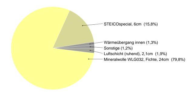
Raumluft: 20°C / 50% Außenluft: -5°C / 80% 18,7 °C Oberflächentemp.: Dicke: 33,4 cm
